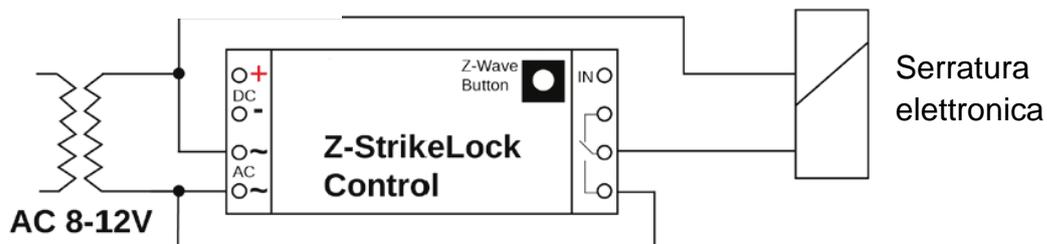
Per prima cosa è necessario installare la parte meccanica. Se è presente un trasformatore elettrico fare riferimento alla **figura 1**, se invece l'apriporta è alimentato a batteria seguire lo schema di **figura 2**.
