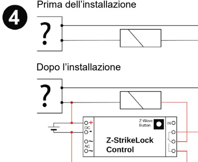
Non è rilevante se si usi un trasformatore o la batteria per alimentare il dispositivo. Il polo positivo della batteria è collegato tramite un cavo alla serratura. L'altro cavo alla serratura deve essere tagliato e collegato ai morsetti (out 0) e REL del modulo di controllo dove il cavo all'apriporta deve essere collegato a REL. Dopo questa modifica, il citofono riprenderà a funzionare come prima.
