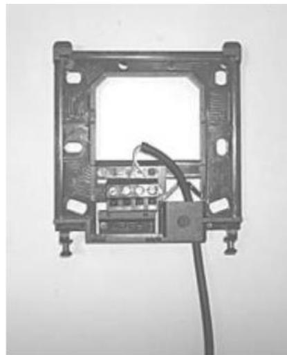
**Attenzione!** Prima di ricongiungere la piastra posteriore con la parte anteriore del sensore di temperatura ed umidità, è necessario creare tagliare la linguetta di plastica presente sul dispositivo così da poter far passare comodamente il cavo (vedi immagine).
